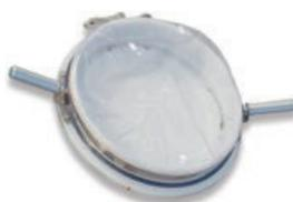
7. Falso container da utilizzare in fase di decontaminazione della parte Alpha
